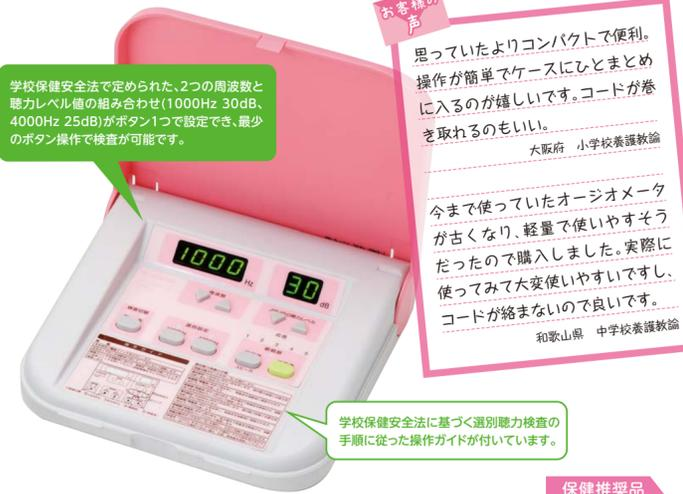
学校保健安全法で定められた、2つの周波数と聴力レベル値の組み合わせ(1000Hz 30dB、4000Hz 25dB)がボタン1つで設定でき、最少のボタン操作で検査が可能です。
