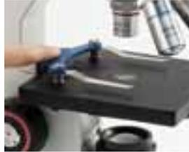
指で押すだけで2本のクレンメルが同時に上がるため、プレパラートを簡単に装着でき、クレンメルの破損も防ぎます。
