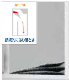
本体を少し傾けることを何回か繰り返すことによって、断続的に土砂が堆積し、縞状の地層ができます。
