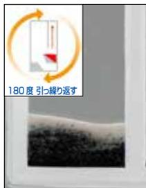
粒の大きいれきは下の方に堆積し、粒の小さい砂や泥は上の方に堆積することを調べられます。
