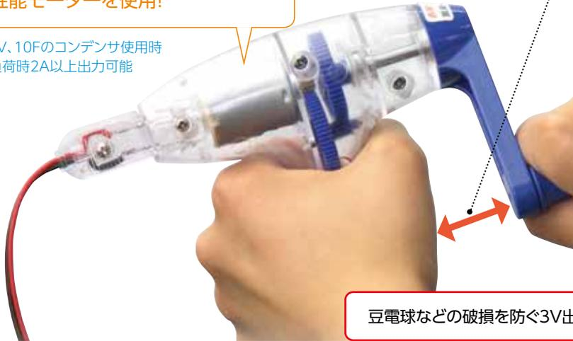
豆電球などの破損を防ぐ3V出力タイプ!
