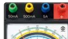
端子の色と目盛が対応しているので、接続した端子がどの目盛に対応しているか一目でわかり、読み取りがスムーズに行えます。また接続する端子の指導も色での指示ができるので、繋ぎ間違いを防ぐことができます。
