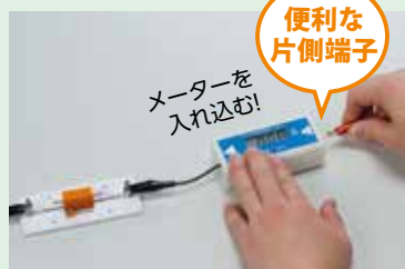
電流計の端子に接続
