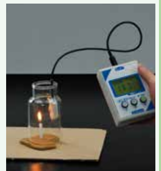
物が燃える前と物が燃えた後とで、空気がどのように変わるか調べる。
