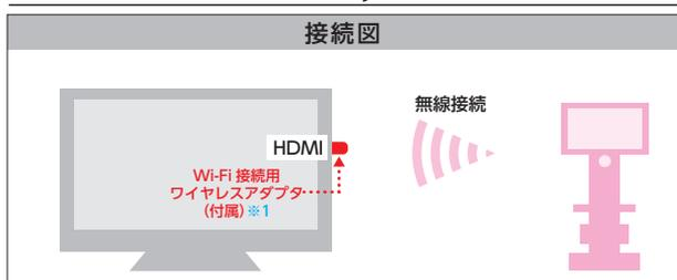
※1 Wi-Fi 接続用ワイヤレスアダプタは、USB による給電が必要です。テレビ側に USB ポートがあれば電源としてご利用いただく便利です。
