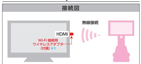
※1 Wi-Fi接続用ワイヤレスアダプタは、USBによる給電が必要です。テレビ側にUSBポートがあれば電源としてご利用いただくと便利です。
