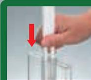
半透膜を付けた仕切り板を差し込むだけでダニエル電池として使えます!
