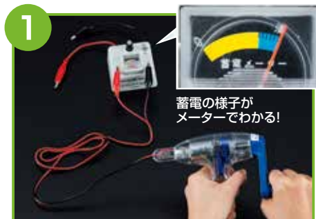
1 手回し発電機などを使って、コンデンサに蓄電します。
