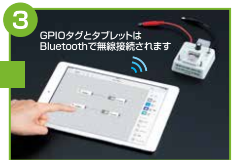
3 GPIOタグとタブレットはBluetoothで無線接続されます お手持ちのスマートフォン、タブレット等の端末(*)に[MESH]アプリをインストールし、プログラミングを行います。
