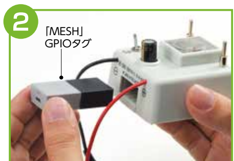
2 [MESH]GPIOタグを背面に差し込みます。
